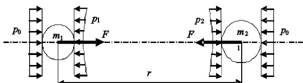
图1 微粒子冲击使两物体相互靠近
