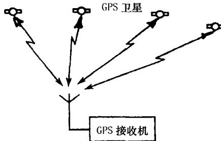
图 4 地面接收机与空中的 4 个 GPS 卫星联系
